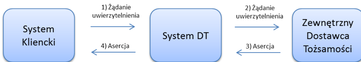
Rysunek 2. Przekazywanie uwierzytelnienia między Systemem Klientkim, DT i ZDT (SAML Proxying)
